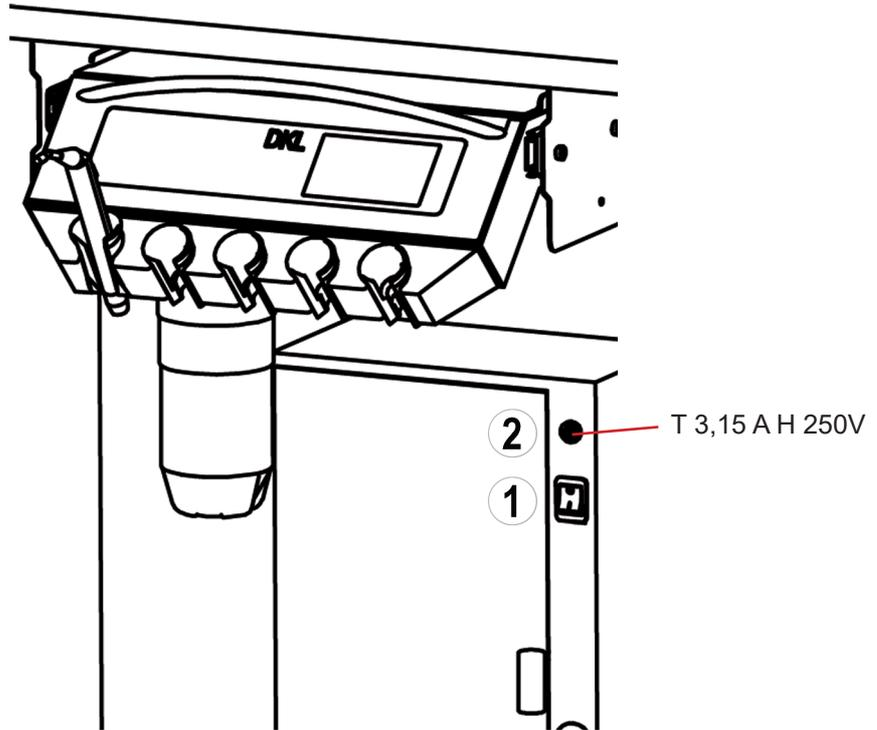
Die Behandlungseinheit verfügt über einen Netzschalter ① an der Stuhlbasis. Der Netzschalter verbindet die Behandlungseinheit mit dem Stromnetz. Bei längeren Standzeiten sollte die Behandlungseinheit vom Stromnetz getrennt werden.
